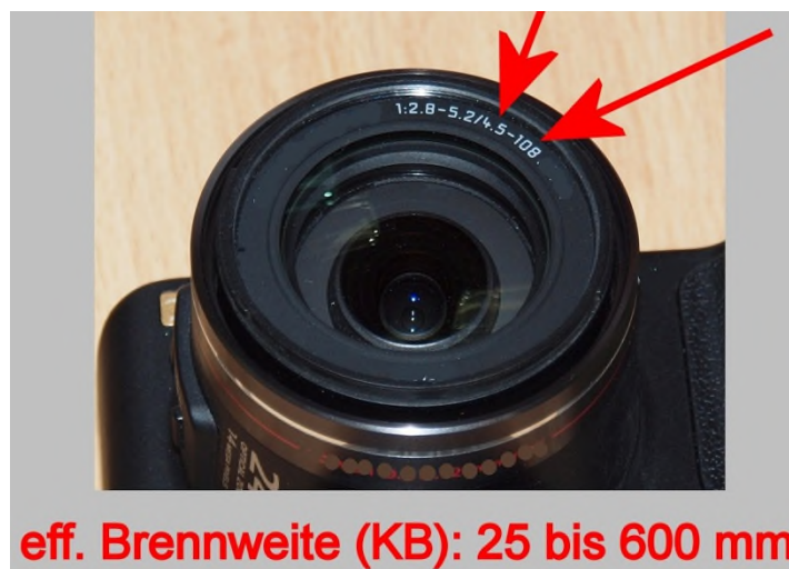
Brennweitenangabe bei einer Bridge-Kamera mit kleinem Aufnahmesensor
